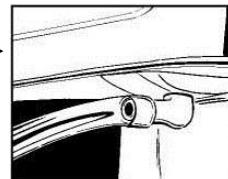
Når du ikke lenger ønsker kontinuerlig drenering fjerner du slangen slik at vannet renner ned i avfukterens vannbeholder. Sørg for at vannbeholderen er riktig montert.
