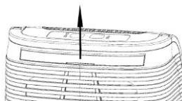
2. Rens filteret med en støvsuger eller med vann. Sørg for at filteret er helt tørst før det settes tilbake i maskinen.
